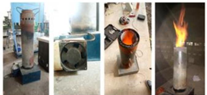
Fig. 4. Small updraft RDF-pellet gasifier
