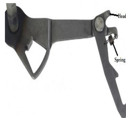
Figure 1. Gear shift rod
