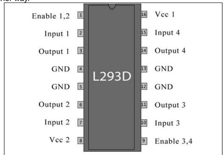
**Fig. 4. L293D Motor Driver IC**
