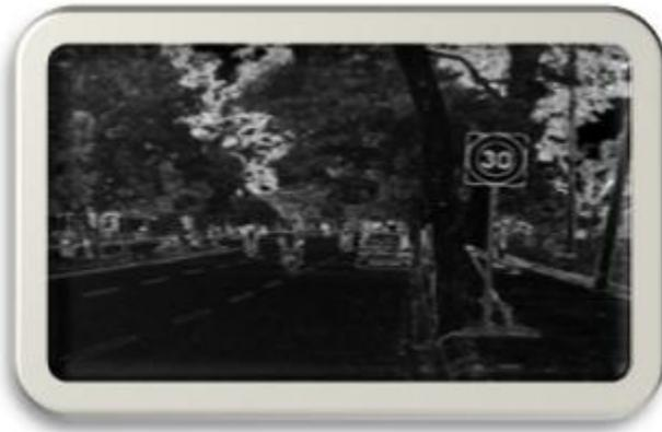
*Figure4. Sobel Edge Detection*
